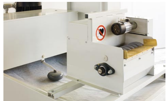
Schwerkraft-Bandfilter mit aufgebautem permanentmagnetischem Filter als Vorabscheider
