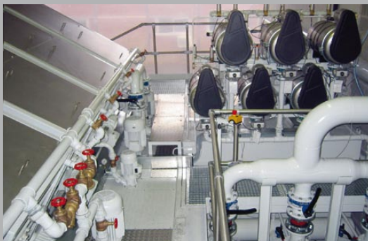
Disc-O-Filter® zur Feinstfiltration auf kombinierter Anlage
