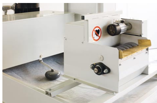
Filtervlies in Schwerkraft-Bandfilter
