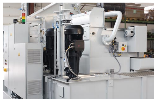
Tiefbettfilter mit Vlies auf kombinierter Anlage
