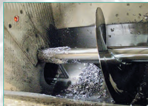
Direkt an der Maschine werden die Späne mit dieser Schnecke dem Unterdruckrohr zugeführt.
