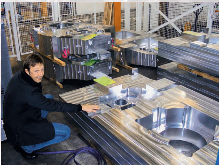
Die fertig zerspanen Aluminium-Werkstücke: Alle Späne sind weg.
