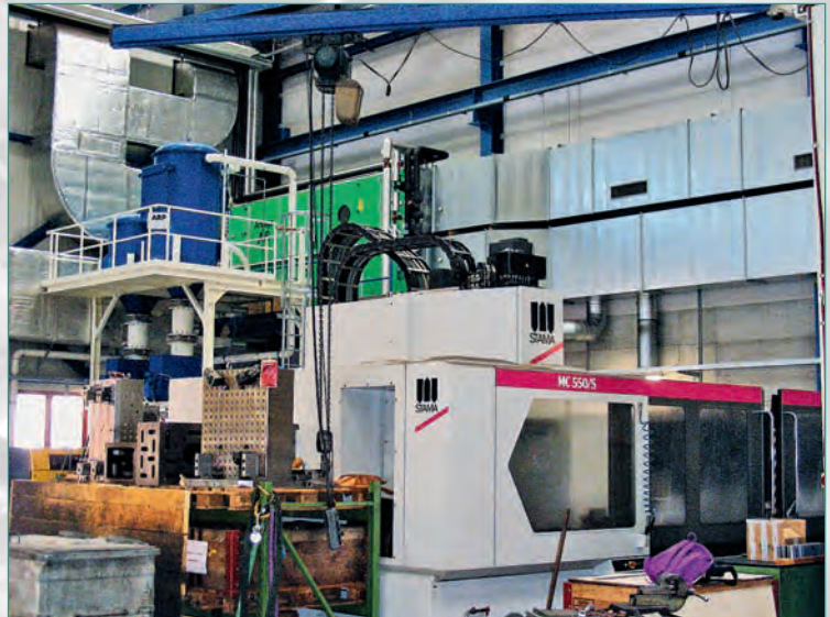
Die Späneaufbereitungsanlage im Hintergrund: Hier werden die Späne zentrifugiert und vom Kühlschmierstoff getrennt. Rechts im Vordergrund ein BAZ von Stama.
