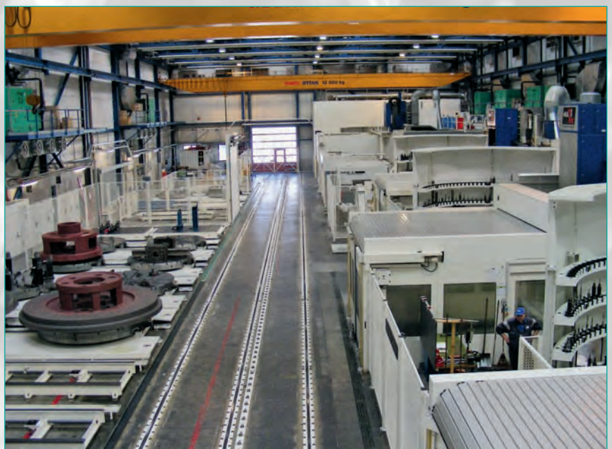
Blick in eine der modernsten Fertigungshallen Europas. Acht Grossbearbeitungszentren bei Ruag Components AG in Altdorf produzieren derzeit 24 Stunden pro Tag und 7 Tage die Woche Späne.
