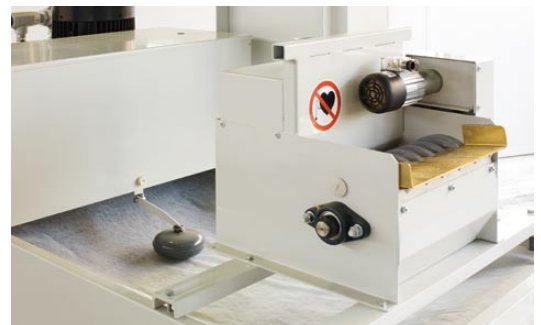
Schwerkraft-Bandfilter mit aufgebautem permanentmagnetischem Filter als Vorabscheider
