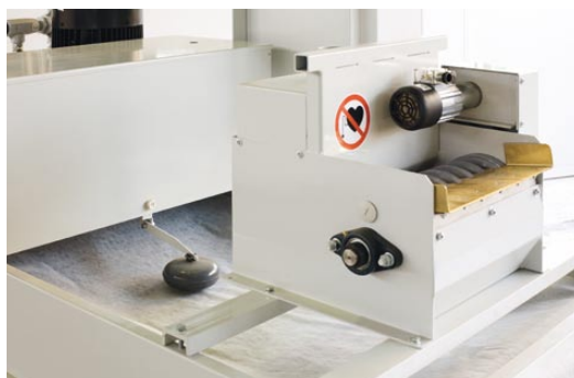
Filtervlies in Schwerkraft-Bandfilter
