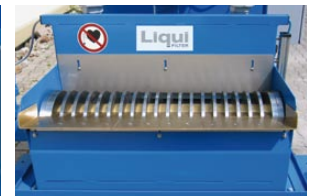
MW 750 - 2000 mit höheren Kammscheiben
