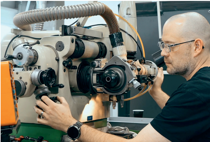
Daniel Käser beim Nachschleifen. Auch hier entsteht der Vollhartmetallstaub, Mikron klein. Die entscheidenden Grössen sind Saugdruck und -geschwindigkeit, um die schweren Partikel restlos abzusaugen.
