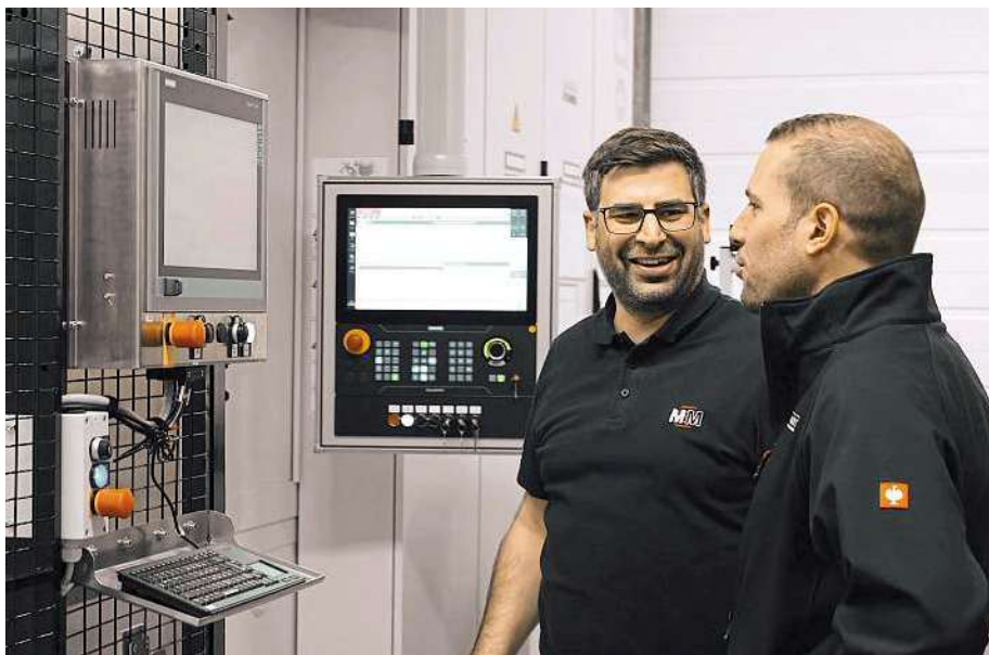
Benjamin Klenk et Marcel Sütterlin devant l'ordinateur central qui donne en un coup d'œil toutes les données sur l'état de la machine, les outils, les dispositifs de serrage, les périphériques, les composants d'automatisation, et la productivité.
