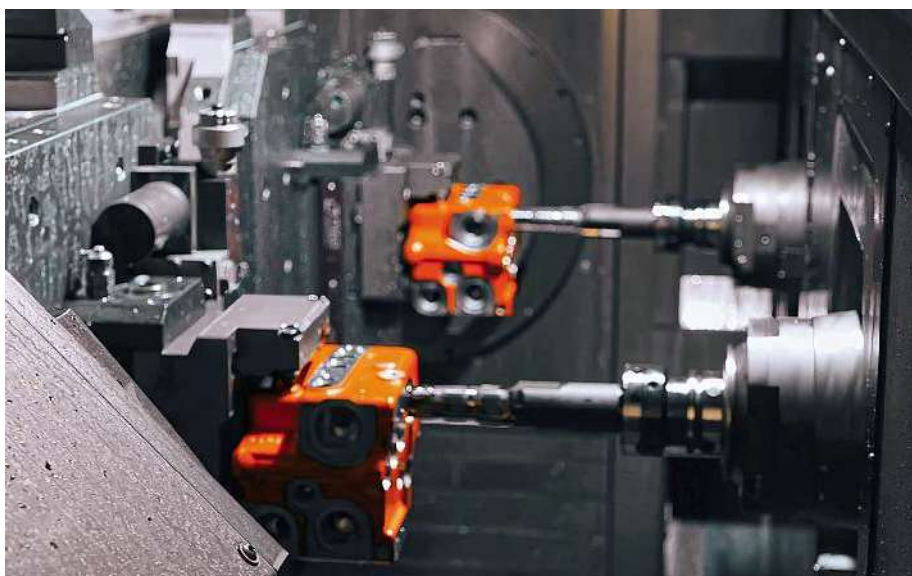
Vue de la zone de travail du centre d'usinage bibroche Grob G520F avec changeur de palettes pour le chargement/déchargement pendant l'usinage, 2 x 120 outils. Usinage complet, puissant et précis, à haute productivité.
