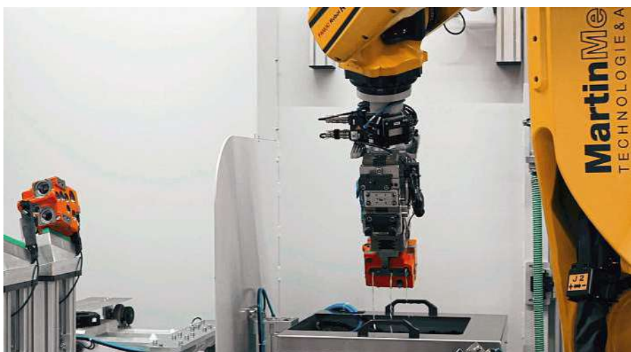
Le processus de finition intégré après usinage comprend l'ébavurage/brossage, le gaufrage à l'aiguille et le nettoyage. Les pièces sont prêtes pour le stockage dans la zone de stockage des composants.
